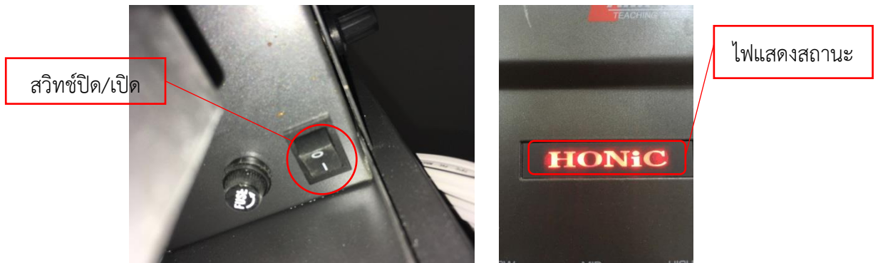
รูปภาพที่ 4- 5 สวิทช์ปิด/เปิดเครื่องขยายเสียงประจำห้องเรียน และไฟแสดงสถานะพร้อมใช้งาน
