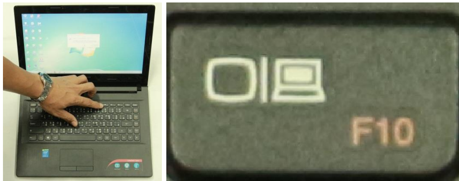
รูปภาพที่ 4- 19 เชื่อมต่อโหมดเข้าสู่เครื่องโปรเจคเตอร์ (Projector)
