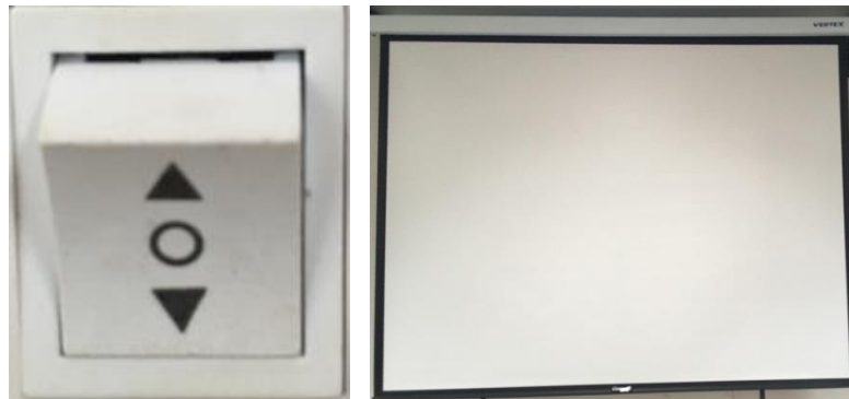
รูปภาพที่ 4- 13 ปุ่มนำจอฉายภาพ (Screen) ลงใช้งานและจอฉายภาพ (Screen) ที่พร้อมใช้งาน
